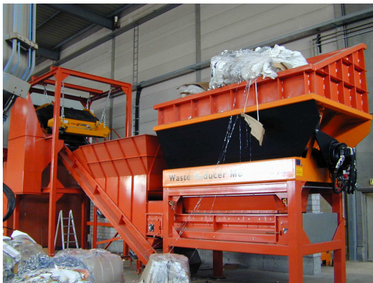
Abb. Vorzerkleinerer mit nachgeschaltetem Überbandmagnetabscheider
