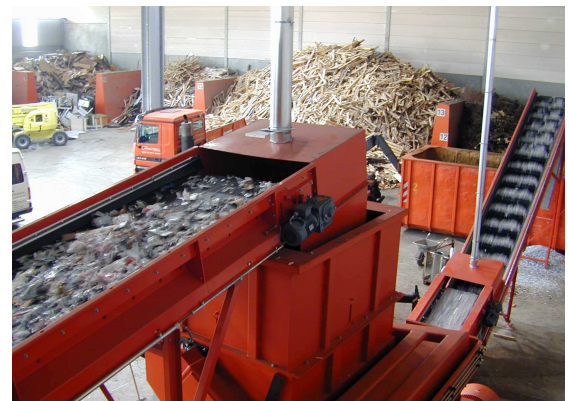
Abb. Nachzerkleinerer von oben mit Austragsband
